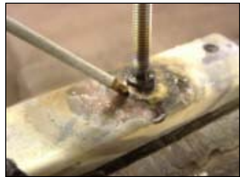
Lotstab zuführen und mit der Flamme schmelzen (Dazu fehlte mir leider eine 3. Hand beim Knipsen)
